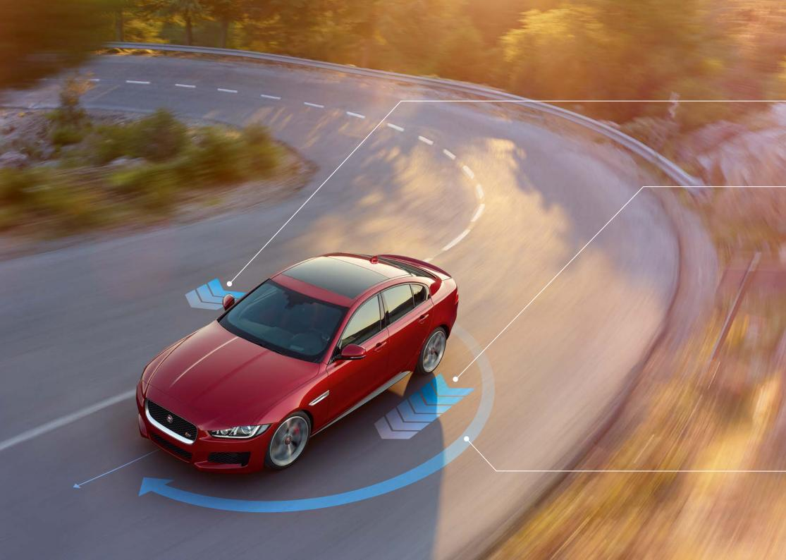
TORQUE VECTORING APPLIES BRAKE PRESSURE TO SLOW THE INSIDE FRONT AND INSIDE REAR WHEELS INDEPENDENTLY.
